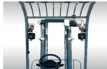
El mástil de visión amplia de nuevo diseño amplía la visión de los operadores de manera efectiva y reduce el área ciega para brindar una visión más clara.
