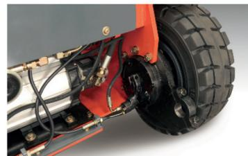
Elevación y conducción con motor de CA, eje delantero con freno húmedo, libre mantenimiento.
