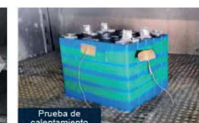
Prueba de calentamiento
