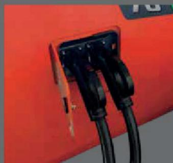
La grúa horquilla de batería de litio está equipada como estándar con un cargador de pistola doble, que reduce considerablemente el tiempo de carga. Las baterías de litio tienen capacidad de alta densidad y pueden ser utilizadas y cargadas en cualquier momento para realizar una operación eficiente y continua a lo largo de todo el día.
